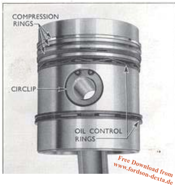
Fig. 23 Piston Ring Lay-Out
